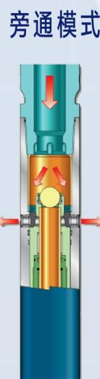
泵压作用在活塞阀上，将其下推，打开旁通孔，此时泥浆流向环空，不流向钻具或者钻头
